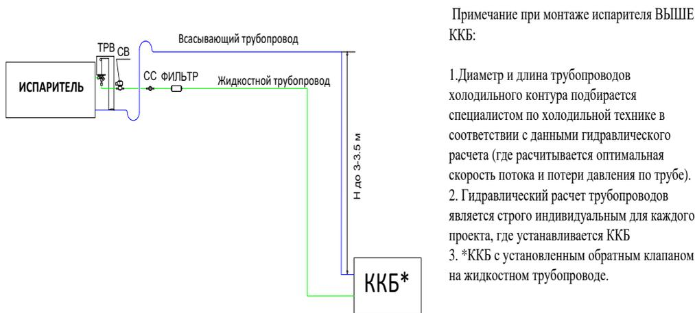
**Рис.9.9. Рекомендации при монтаже испарителя выше ККБ**
